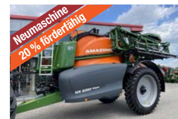
Amazone UX 5201 Super (30 m) Bj 2022 Symbolfoto, Lenkachse 28°, hydr. klappbar, 2100 mm Spur, nachlaufeinr., hydr. Stützfuß, 520 l/min Pumpe, ... Preis auf Anfrage
