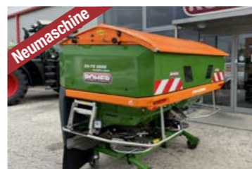
Amazone ZA-TS 2600 Profis Hydro (2600 l) Bj 2023 Wiegezellensteuer, hydr. Antrieb, el. Einleitsystem, LED-Bel., man. Abdeckrollplane S, Streuschaukelauflaufsatz TS20 Preis auf Anfrage
