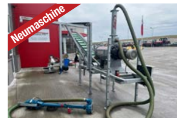
Fliegl Tapir 375 Gülleseparatör Stapleraufnahme, 32 A Stromversorgung, Schaltschrank, Ansaug-/Überlauf-/Rücklaufschlauch, höhenverstellb. Füße Preis auf Anfrage
