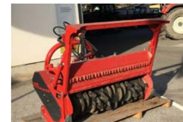
Prinot M450m-1450 (145 cm) Bj 2020 20 h, Gestrüppmulcher, mech. Antrieb, ab 75 PS, Kettenvorhang, 165 cm Gesamtbreite, hydr. Klappe, 450 kg, ... Preis auf Anfrage
