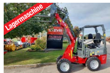
Weidemann 1140 Light (25 PS) Bj 2023 Hydrostat, hydr. Verriegelung, Schnellwechsellager, Hydraulikkühler, BL Palettengabel 1000 mm, Achse K75, ... Preis inkl. 20 % MWSt. EUR 32.900,-
