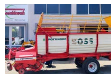
Pöttinger Ernteboss I (28 m³) Bj 1990 Dosierwalzen, Kurzschnitt, hydr. Knickdeichsel/Bremse/Rückw./Kratz-, Querförderband (gerissen), 165 cm Pickup Preis inkl. MWSt./Verm. EUR 10.900,-
