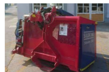
Siloking Mayer EA 2300 (2,3 m³) Bj 2014 Silokamm, Austragung re., Dreipunkt Kat. 2, Restgutklappe, 1 Dosierwalze re., max. 3,2 m Entnahmehöhe, ... Preis inkl. MWSt./Verm. EUR 5.999,-
