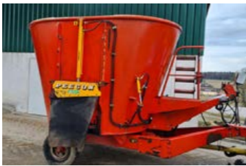
Peecon VME075 (8 m³) Bj 2001 6.500 h, Schnecken vertikal, beidseitiger Austrag, gezogen, Stützfuß, ... Preis inkl. MWSt./Verm. EUR 6.500,-
