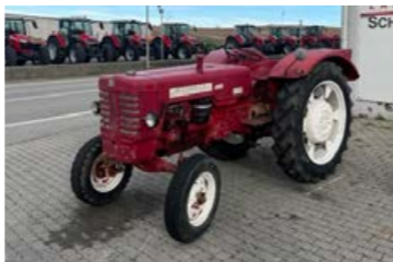
International D 440 (40 PS) Bj 1958 funktionsbereit, Hinterradantrieb, Kompressor Aufladung, 23 km/h, 6.00-16 (20 %) vo, 11-36 (20%) hi, ... Preis inkl. MWSt./Verm. EUR 8.900,-
