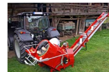
AMR Vogesenblitz Quatomat Trommelsäge 250 - 520 mm Schnittlängen, starres od. schwenkbares Förderband, ZW-Antrieb (optional mit E-Motor kombinierbar) Preis inkl. 20 % MWSt. ab EUR 15.400,-
